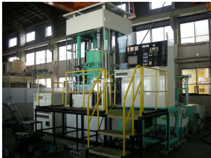
写真【フランス原子力庁向けに受託した大型 SPS 焼結装置】
