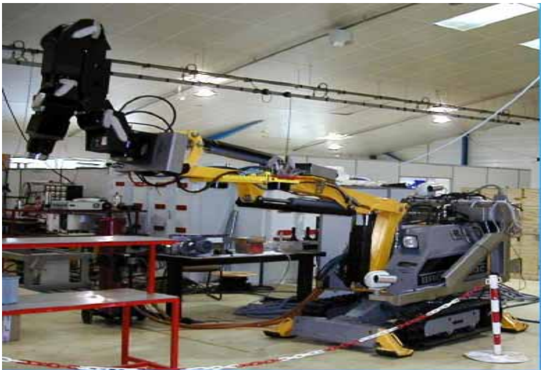
（実例のひとつ）遠隔制御による小型ブルドーザー搭載アームシステム
